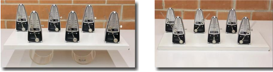
FIGURE 7.11 Six métronomes de même fréquence d'oscillation oscillent sur une même plaque de bois. Lorsque la plaque peut rouler sur deux cylindres en Plexiglas, les métronomes se synchronisent, sinon ils se désynchronisent.
